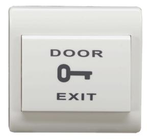
Pulsador de liberación de puerta Salida contacto NO/NC/COM Testado 500.000 usos 3A DC36V max Montaje empotrado Medidas 88x88x20 mm Fabricado plástico
