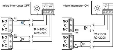
Los relés se pueden utilizar para actuar sobre cualquier tipo de circuito eléctrico, pudiendo actuar de forma NA o NC dependiendo de los bornes utilizados. Verifique en el apartado de Características Técnicas el valor de corriente y tensión máxima de los contactos de los relés.
